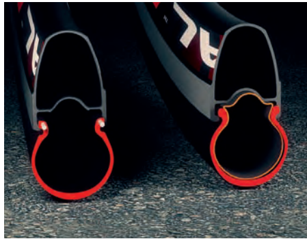
Der Tubeless-Reifen ist ein schlauchloser Reifen, weshalb Reifenplatzer durch Einklemmen des Fahrradschlauchs nicht mehr möglich sind.
